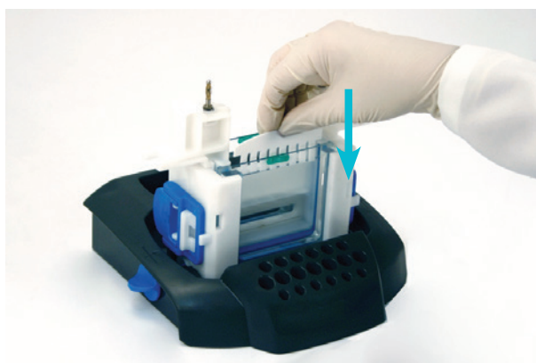
Figura 18: Colocação dos pentes.
