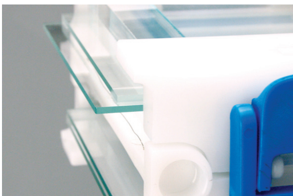
Figura 12: Posição incorreta, vidros desalinhados.
