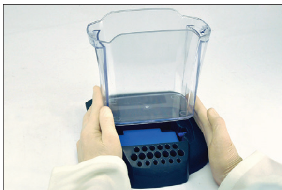
Figura 5: Retirada do tanque da base.
