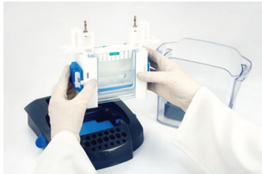
Figura 21: Retirada do módulo de corrida.
