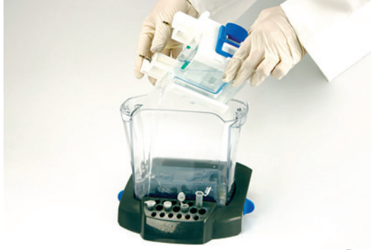
Figura 34: Retirada do tampão do módulo de corrida.
