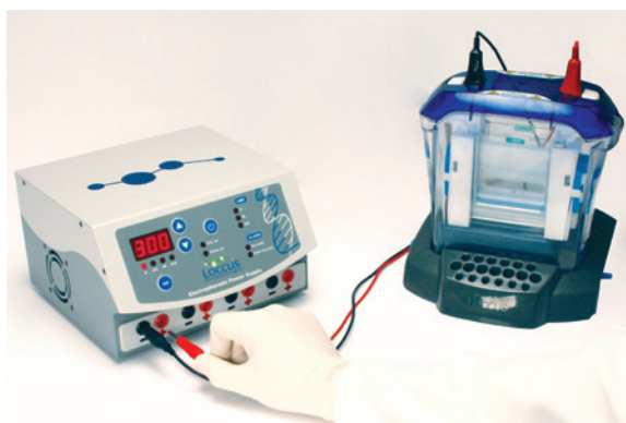
Figura 31: Conexão dos cabos à fonte.
