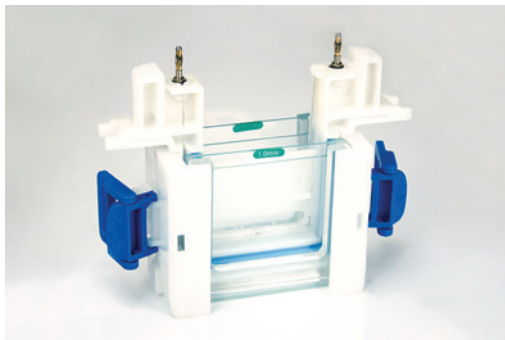
Figura 35: Módulo de corrida com travas soltas.
