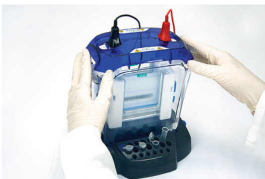
Figura 26: Colocação da tampa.
