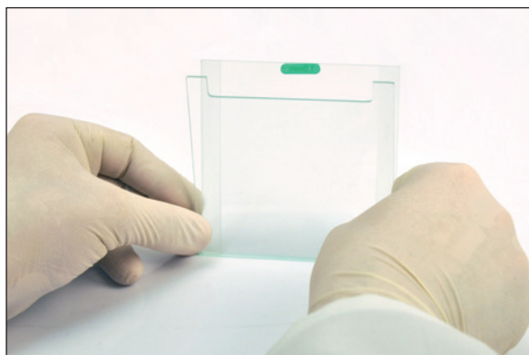
Figura 6: Montagem do conjunto de placas de vidro.
